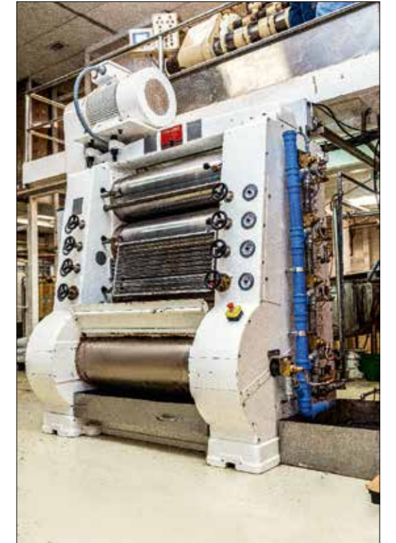
La alta mecánica italiana, ilustrada aquí por una refinadora peta cilíndrica Carle & Montanari, ha sido fulcro del procesamiento del cacao hasta el chocolate del Grupo Rizek.
