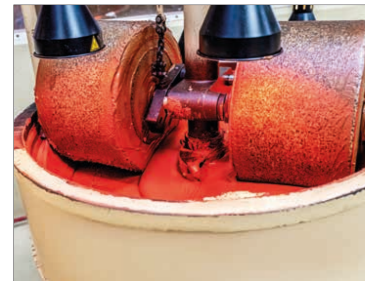
Un macchinario italiano, marca Carle & Montanari, impiegato per la lavorazione della pasta di cacao.
