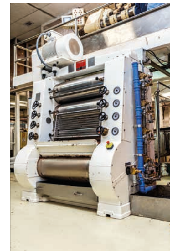
La meccanica italiana di alta precisione, qui illustrata da una raffinatrice cilindrica Carle & Montanari, è stata il fulcro di ogni fase della lavorazione del cacao del gruppo Rizek fino al cioccolato.
